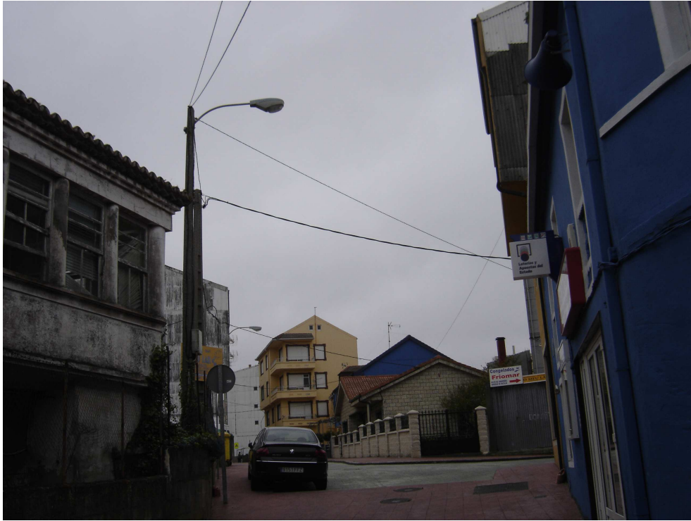
Exemplo do mantemento moi estendido de luminarias pouco acaídas para o ámbito.
